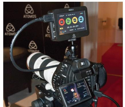
Canon EOS Cinema C100: l'avvio e il termine della registrazione possono essere comandati direttamente dalla telecamera attraverso la stessa interfaccia HDMI utilizzata per la registrazione del video.
