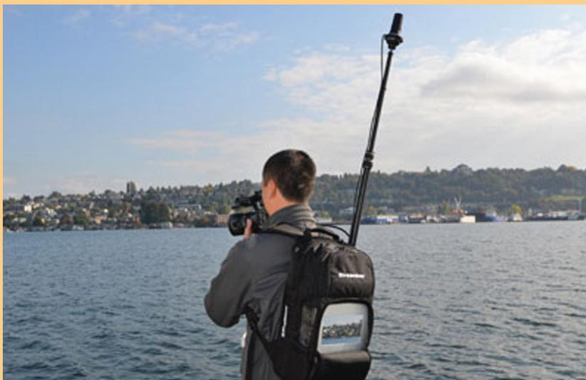
Il sistema permette di montare antenne ad alto guadagno per applicazioni dove il segnale sia limitato.
